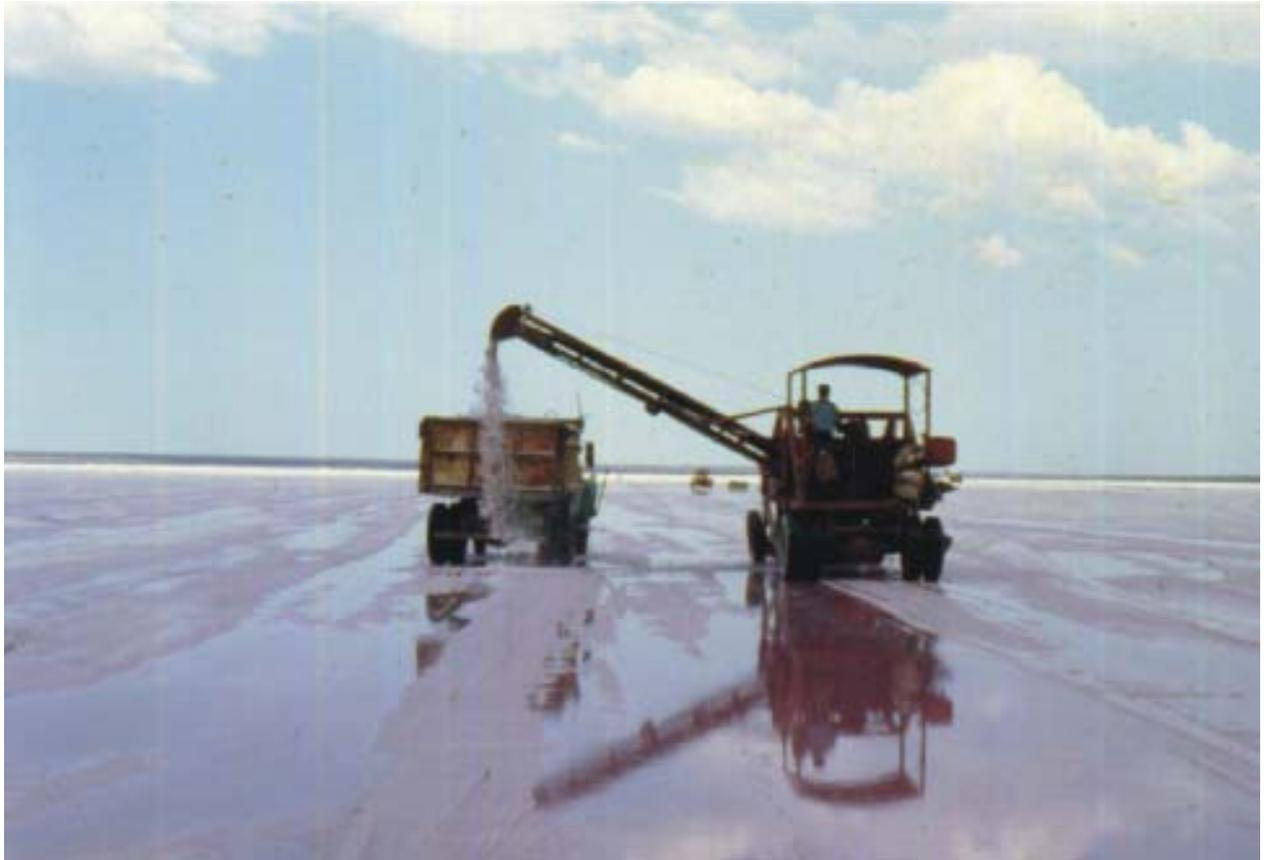
**Figura 40.** Recolección. Se utiliza maquinaria específica provista de un sistema de cangilones que levanta la sal acordonada, depositándola sobre una cinta transportadora, que la vuelca sobre la caja del camión, mientras avanzan ambos simultáneamente. Foto: At. Lic. N. Coriale, DMBA.
