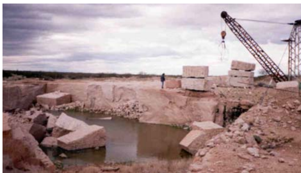
Figura 19. Frente de explotación de la cantera Larrosa. A la derecha, pluma para carga de bloques.
