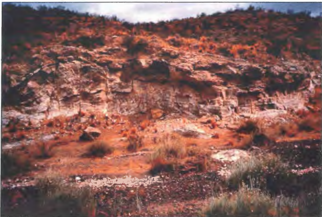
Foto 4: Se observa una antigua explotación de yeso que muestra un frente de 8 metros de potencia (Panorámica)
