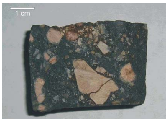
Figura 31. Mina Lomas Moras. Muestra de mano mostrando la textura brechosa y el cemento de óxidos de manganeso.
