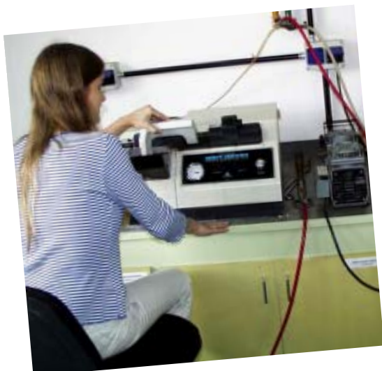
Cortadora y devastadora para la elaboración de cortes delgados
