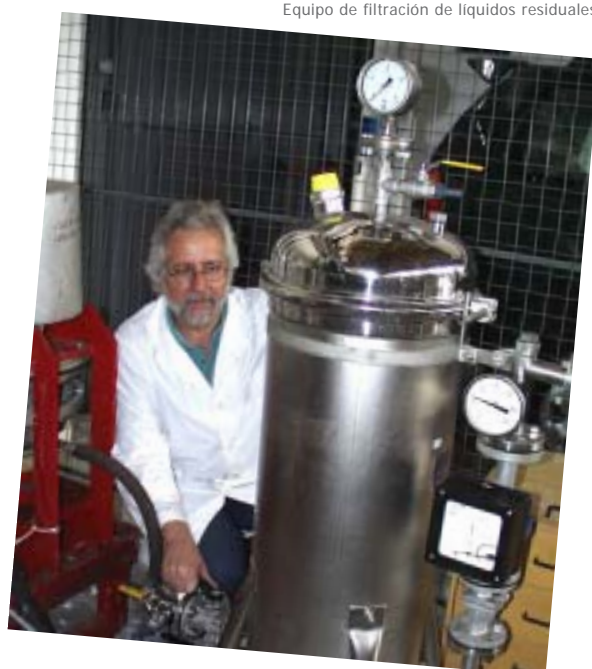
Equipo de filtración de líquidos residuales
