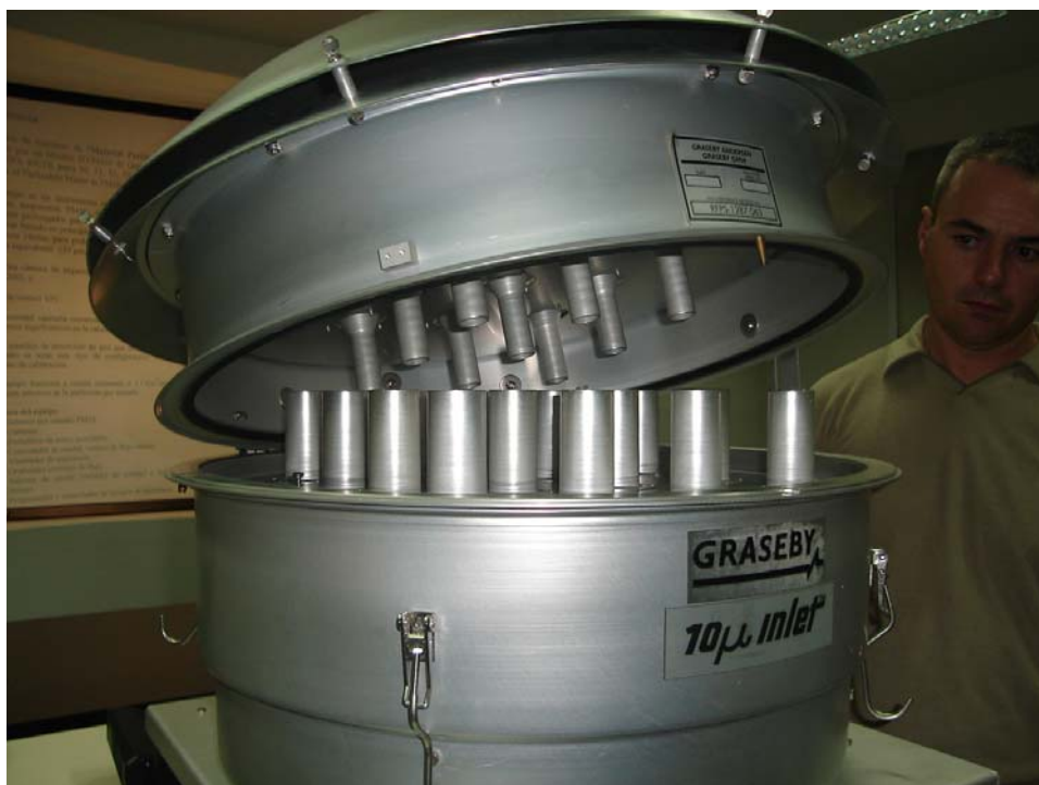
Cabezal separador de partículas menores de 10 micrones.
