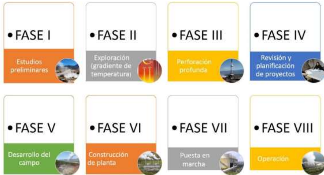
Grafico 1: resume las etapas de desarrollo de un proyecto geotérmico según el Best Practices 2014 del International Geothermal Association (IGA) .
